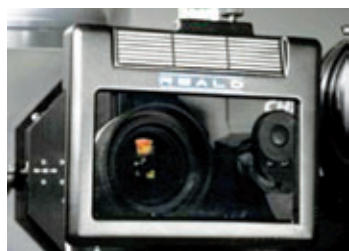
Рис. 6. Поляризующее устройство системы Real D
