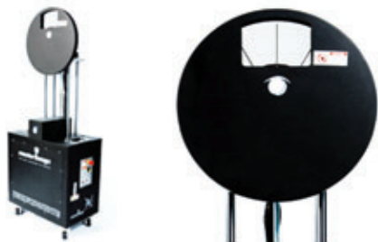
Рис. 7. Подъёмный механизм Master Image с вращающимся поляризующим диском
