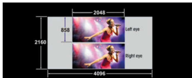
Рис. 9. Расположение кадров стереопары на матрице 4 К в проекторе SONY
